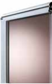
Rahmenprofil mit 20-mm-KS-Doppel-scheibe – braun getönt; Lichtdurchlass: ca. 50%
