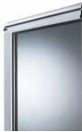
Rahmenprofil mit 20-mm-KS-Doppel-scheibe – grün getönt; Lichtdurchlass: ca. 70%
